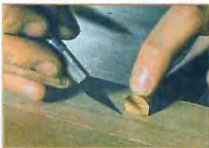
Для створок с защелками и коленчатыми фиксаторами нужны ограничители. Их устанавливают в гнездах, выбранных посередине основания корпуса.
