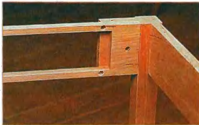
Чтобы ножки не разъезжались, рамку выдвижных ящиков крепят шурупами к задней стороне фрагментов передней царги.
