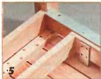
5 Выдвижной элемент удерживается алюминиевыми направляющими шиной, ...
