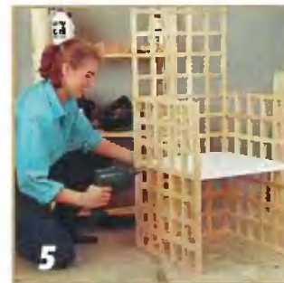
Основание столика можно склеить, усилив соединения тонкими гвоздиками.
