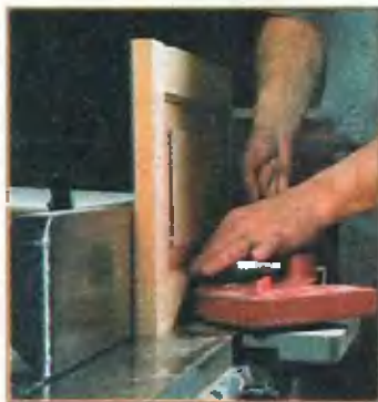
При открывании створки не соприкасаются за счет скоса кромки под углом 2°.
