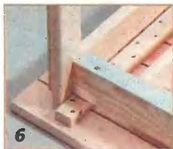
6 ... которые привинчены снаружи и снизу заподлицо с продольными царгами.
