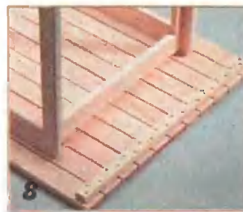
8 Откидной элемент опирается на выдвинутую часть подстоля.
