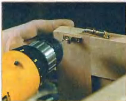
Временное крепление. Чтобы точно просверлить направляющие отверстия, основную часть крепят на створке двухсторонней липкой лентой.
