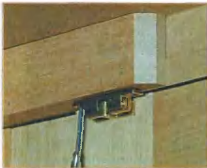
Защелки с двойными шариками используют на дверцах с притвором и без него. Ответную часть крепят внутри крышки корпуса.
