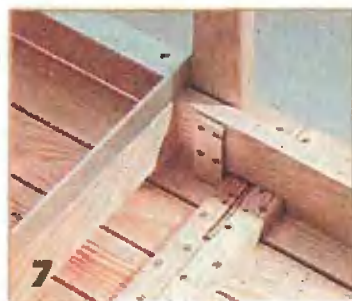
7 Выдвижной элемент выдвигают вплоть до соединительных планок столешницы.
