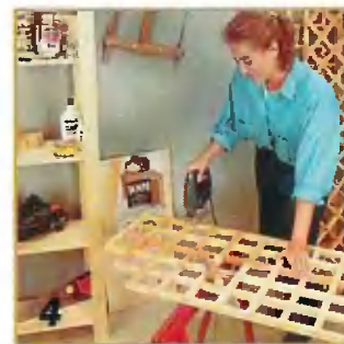
Из большой решётки выкраивают детали основания.
